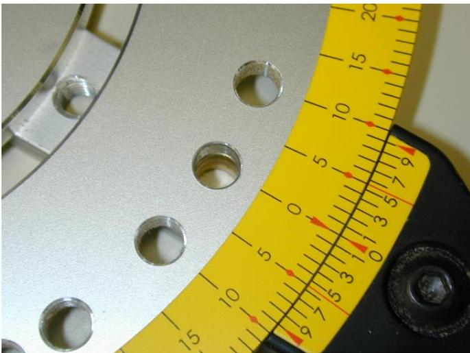
Figura 5: Calibrador vernier para ángulos.
